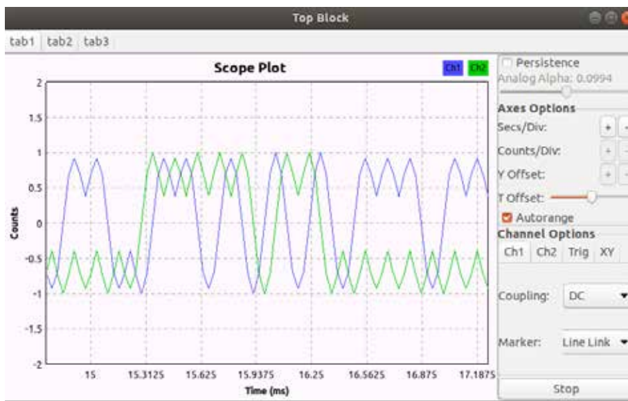
Рис. 13. Відображення форми сигналу в часовій області після модуляції
